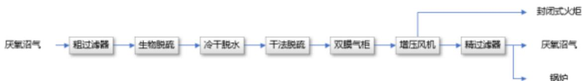
图 3-6 沼气净化系统工艺流程图
