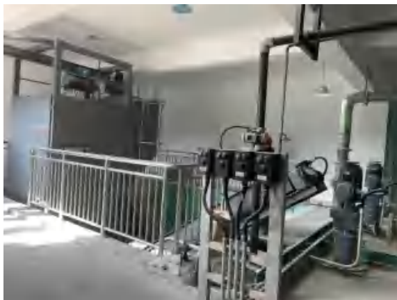
吨包破碎装置
