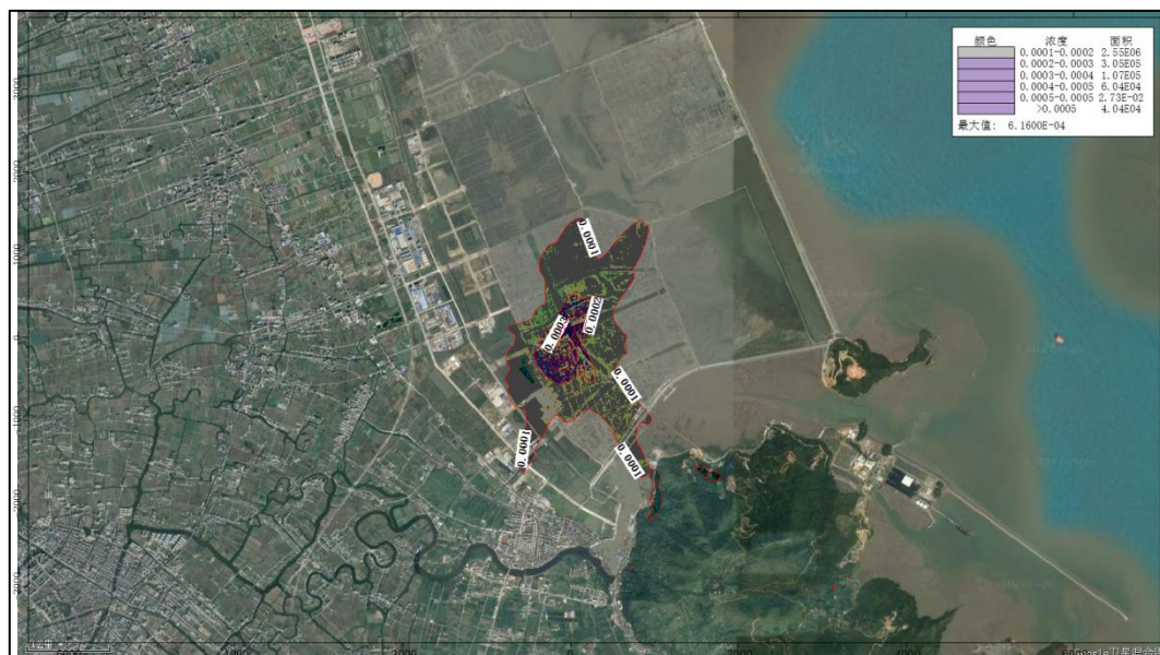
图 5.1-6 氯化氢日均浓度贡献值等值线分布图-正常工况
